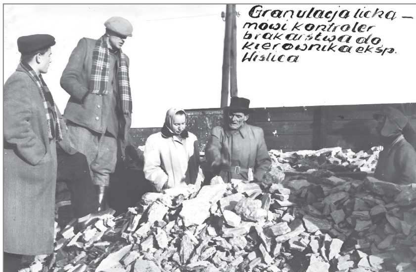
59. Fotografia wykonana około 1956 r. podczas kontroli granulacji surowca (wydobyczego przez Spółdzielnię Pracy „Kopaliny Mineralne” w Kielcach) na stacji wąskotorowej „Wiślica” w Koniecmostach. Komentarz dopisany na zdjęciu: „Granulacja licha – mówi kontroler brakarstwa do kierownika eksp[loatacji] Wiślica”. Źródło: SPKM, Księga pamiątkowa (1951–1975), k. 12.
