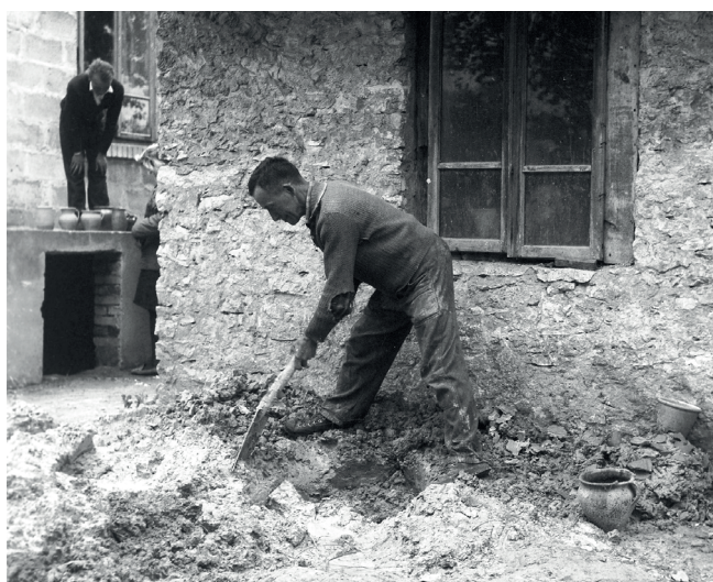
Fig. 7. Garncarz Stefan Sowiński przygotowuje glinę do produkcji (tzw. gnojenie gliny), Chałupki, 1969 r., fot. J. Fijałkowski (MNKi/Pf/1926) • Poterter Stefan Sowiński is preparing clay for ceramic production (clay maceration), Chałupki 1969, photo J. Fijałkowski (MNKi/Pf/1926)
